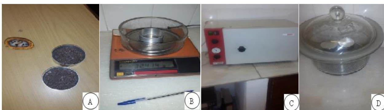
Figura 5: A) semente moída, B) balança de precisão, C) estufa, D) dessecador
