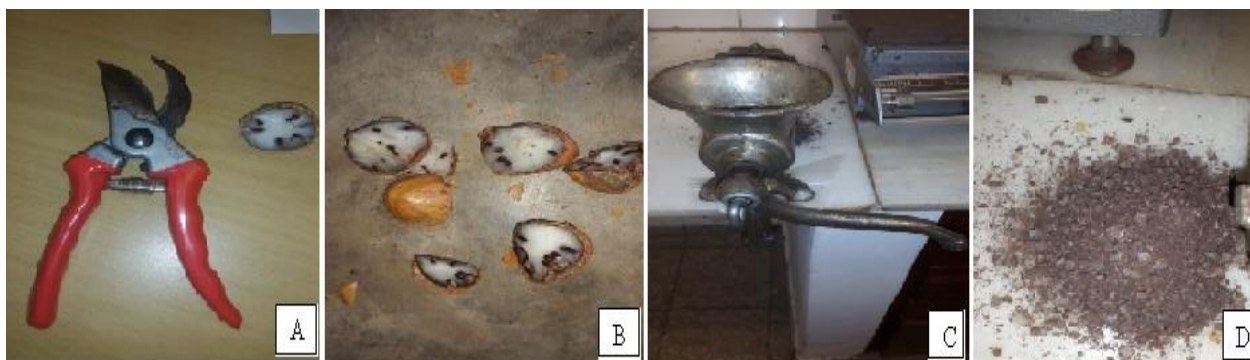
Figura 4: A) Tesoura de poda de cabo curto, B) Sementes quebradas, C) Máquina de moagem de sementes, D) Sementes moída
